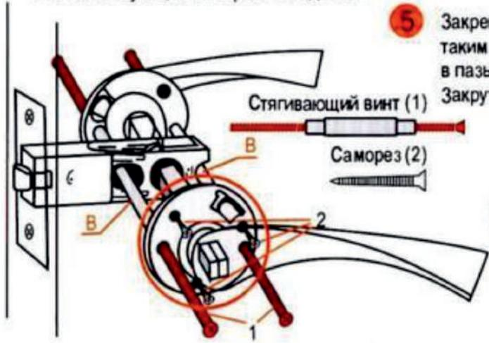
**5** Закрепите ручки на четырёхгранном стержне таким образом, чтобы крепёжные винты попали в пазы четырёхгранного стержня (E). Закрутите до упора крепёжные винты.
