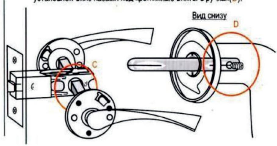
**4** Прикрепите внутренние накладки ручек при помощи саморезов к полотну двери. Используйте стягивающие винты, если врезной механизм имеет в корпусе соответствующие отверстия под них.
