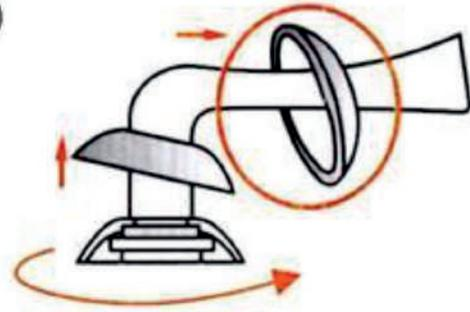
**3** Установите ручки с внешних сторон двери таким образом, чтобы четырёхгранный стержень прошёл через отверстие в дверном механизме (C). Четырёхгранный стержень должен быть установлен вниз пазами под крепёжные винты в ручках (D).
